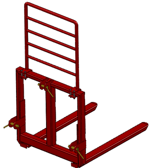
Abb. 2.4.2-P46-(A)/(B) mit demontabler Erhöhung
