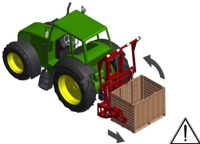
*Stellen Sie die Oberklemme mit dem Klemmzylinder hoch, bevor die Kiste mit dem Vornüber-Drehgerät aufgenommen wird.*
