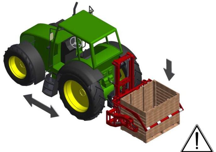
*Halten Sie beim Transport die Last so niedrig wie möglich, um das Transportgerät so stabil wie möglich zu halten. Klemmen Sie die Kiste während des Transports*
