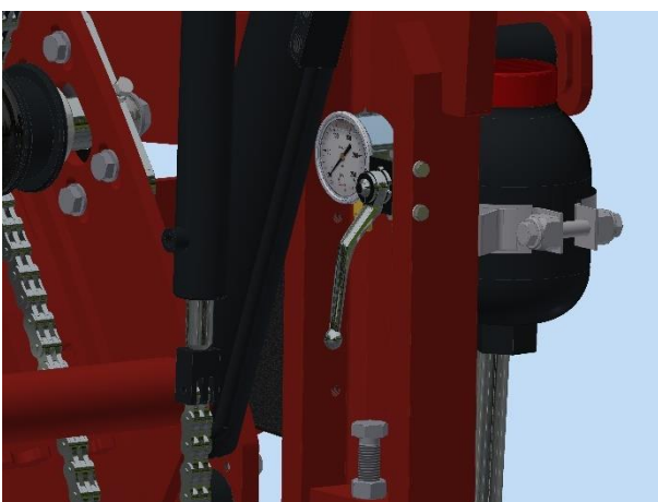
Figuur 3.2.4-Hydraulisch circuit retourkanteling
