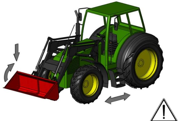
*Sorgen Sie dafür, dass die Schaufel beim Aufnehmen der Ladung waagrecht oder etwas nach vorn gekippt steht. Achten Sie darauf, dass das Messer nicht unter oder hinter einen eventuellen (Beton-)Sims gerät, um Schäden zu vermeiden.*
