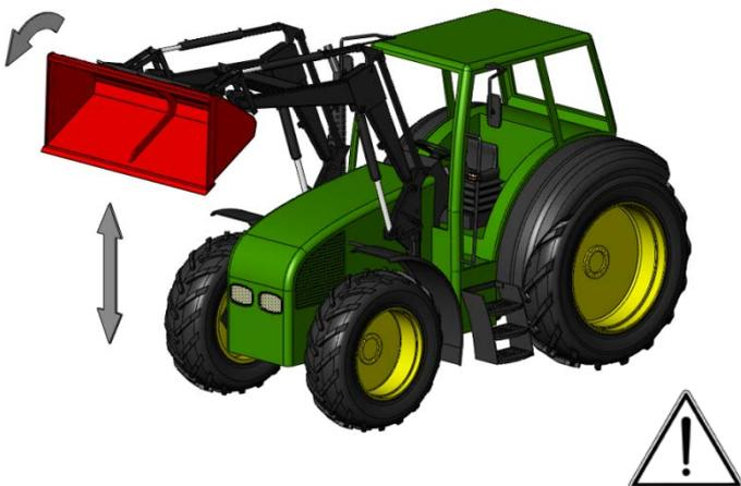
*Sorgen Sie dafür, dass beim Abladen ausreichend Abstand zwischen der Schaufel und dem Untergrund eingehalten wird, um unnötige Schäden an der Schaufel zu vermeiden.*
